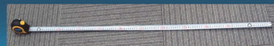
巻尺にシールターゲットを貼り付けた基準バー
